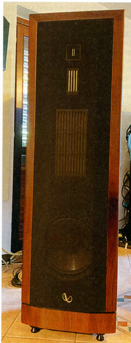
Nonostante tutto compatti, i diffusori Epsilon mostrano in trasparenza i tre trasduttori planari che ne caratterizzano il progetto.
