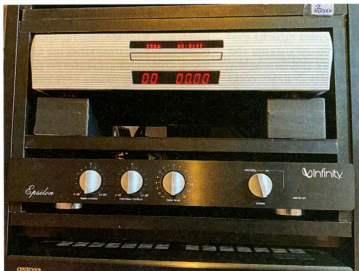
In basso, l'unità di controllo del subwoofer degli Epsilon, definita SCU (Servo Control Unit).
