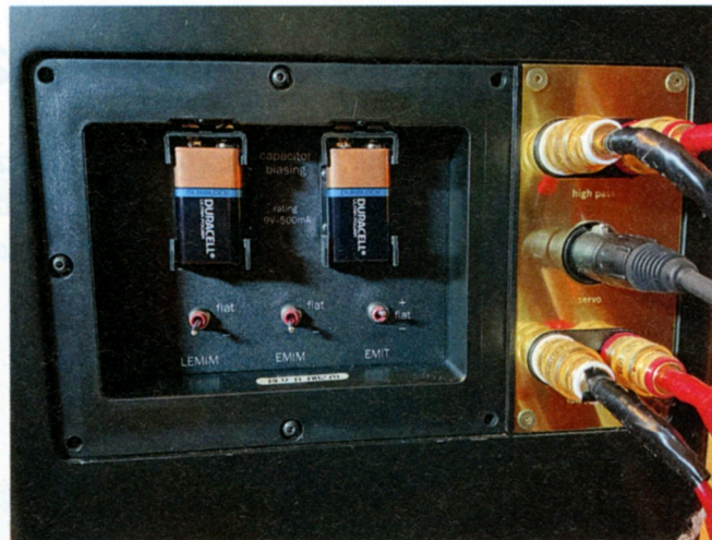
La piastrina è posta a copertura di un vano in cui sono posizionati gli alloggiamenti per due batterie da 9 volt dedicate all'alimentazione del circuito che tiene in tensione le membrane dei midrange, oltre a regolazioni di emissione dei tre planari.
